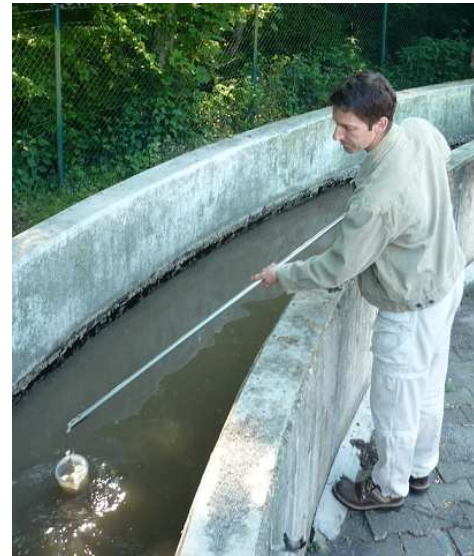
Abb. 1: Erste Probenahmestelle nach dem Rechenbauwerk = Zulauf zum Sand- und Fettfang
