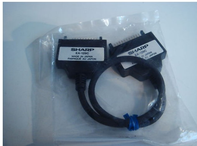
Abb. 1: Das Kabel EA-129c verbindet zwei Sharp 1403 für den Datenaustausch
